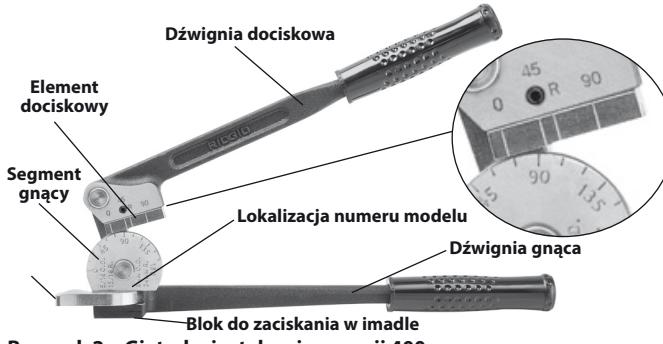
Rysunek 2 – Giętarka instalacyjna z serii 400
